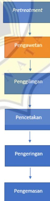
Gambar 8. Alternatif Pengawetan dengan Cara Basah
