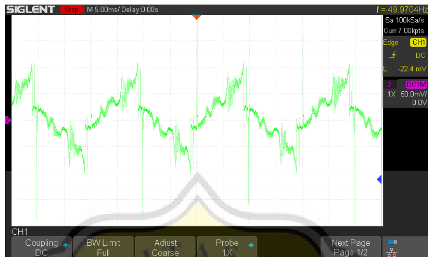
Gambar 4.3 Gelombang tegangan keluaran PLN dengan Inverter
