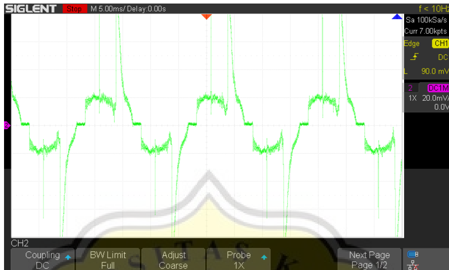
Gambar 4.8 gelombang tegangan keluaran pada PLN ketika Inverter Off
