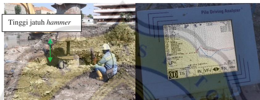
Gambar 4.25 Pengujian beban dinamis di lapangan
