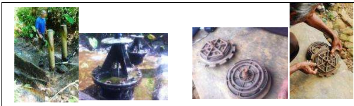
Gb. 15: Pompa Oblok (Hibram) dan Klep Tabung
