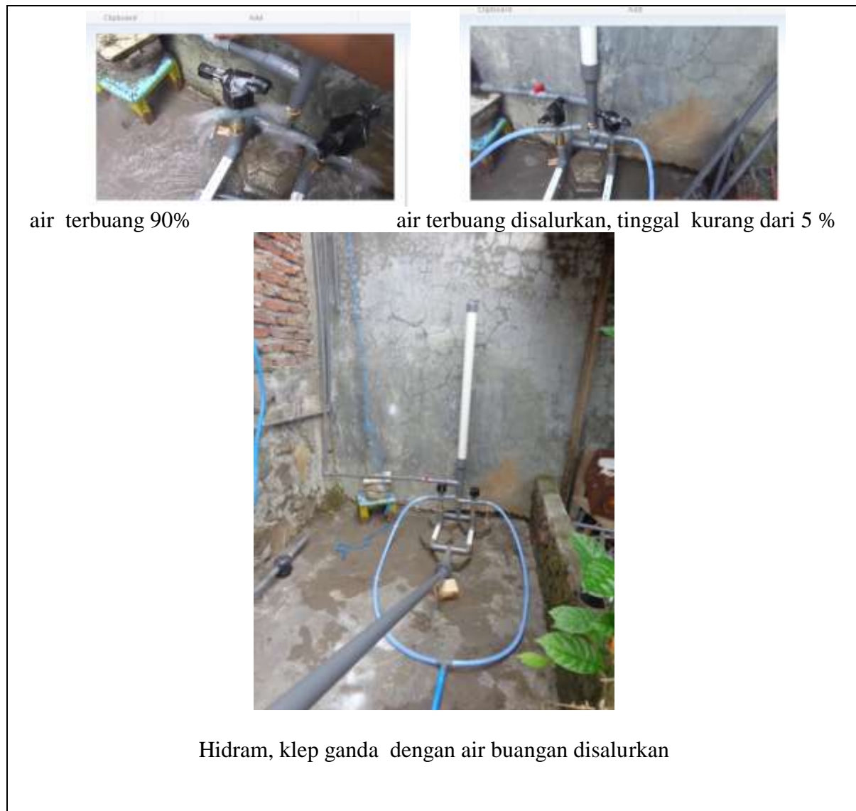
Gambar ...: eksperimen optimalisasi pengelolaan air terbuang pada pompa hidram
