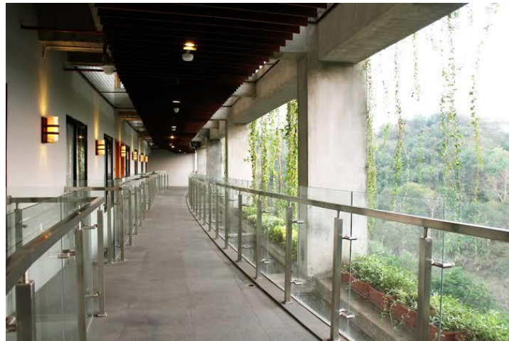
Gambar 32 Contoh penerapan Single Loaded Corridor pada Bangunan Hotel OakTree Semarang Sumber : pegi-peg.com
