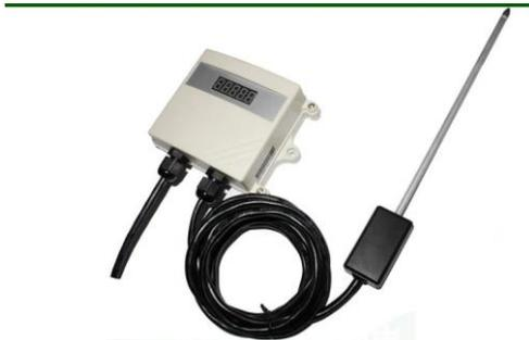
*Gambar 54. Sensor pH Tanah*
