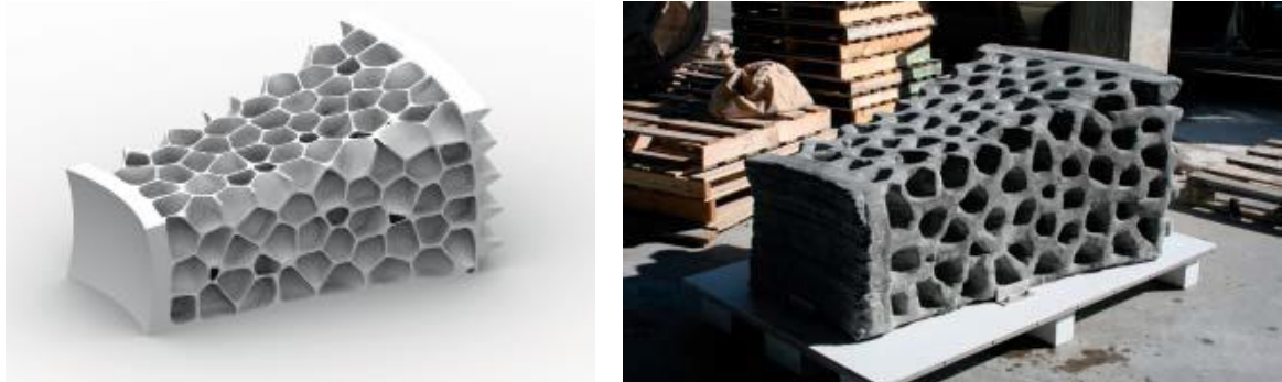
Gambar 82 Bentuk Foam dalam Pencetakan Struktur Pelindung Sumber: (Kestelier, Dini, Cesaretto, Colla, & Pambaguian, 2015)
