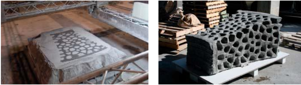
Gambar 53 Proses Pencetakan Lapisan Pelindung dengan Regolith Sumber: (Kestelier, Dini, Cesaretto, Colla, & Pambaguian, 2015)
