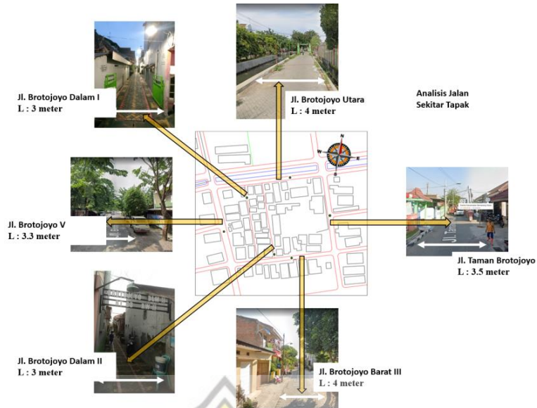
Gambar 3. 113 Infrastruktur Jalan Lingkungan sekitar Tapak Sumber Foto : Google Maps Street View Screenshoot dan Dokumen Pribadi
