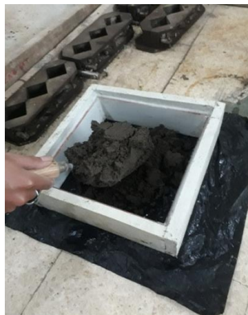
Gambar F.4 Memasukkan Benda Uji ke Dalam Cetakan
