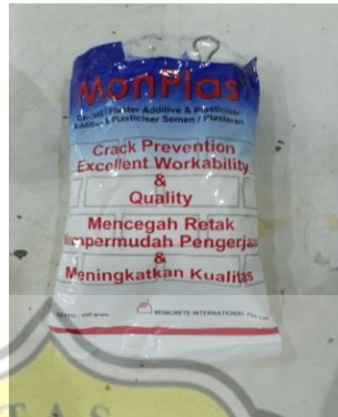
Gambar 3.4 Monplas sebagai bahan tambah anti retak beton
