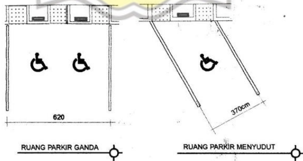
Gambar 43 Variasi Letak Parkir Sumber: Manual Desain Bangunan Aksesibel
