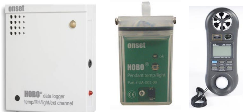
Gambar 5. Ilustrasi alat ukur Hobo U12-012 (kiri), Hobo U002-64 (tengah), dan Lutron LM-8000A (kanan)
