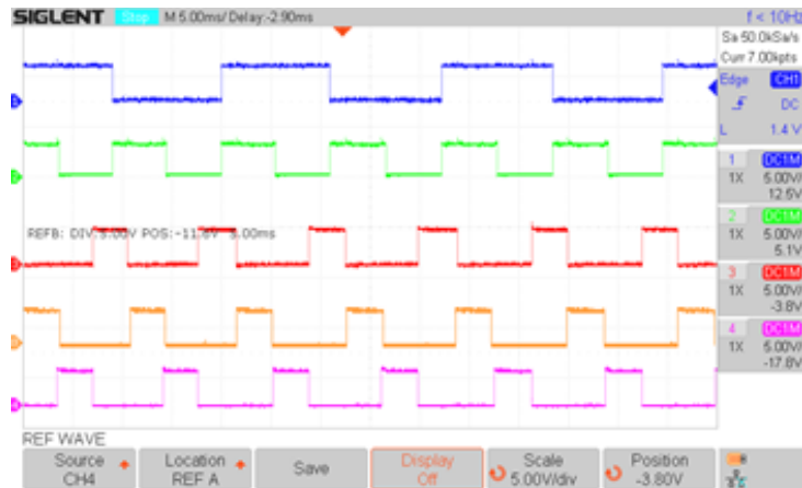
Gambar-4. 9 Hasil sinyal (a) Input Capture (b) hall effect (c) saklar fasa A (d) saklar fasa B (e) saklar fasa C pada Kondisi III
