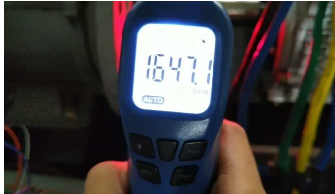
Gambar-4. 12 Referensi Kecepatan Saat SRG Dioperasikan \theta_{on} = 40^\circ dan \theta_{off} = 170^\circ
