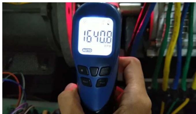
Gambar-4. 15 Referensi Kecepatan Saat SRG Dioperasikan \theta_{on} = 50^\circ dan \theta_{off} = 180^\circ
