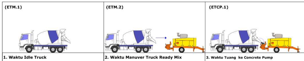
Gambar 3.3 Metode Pengukuran Waktu Siklus *Concrete Pump*
