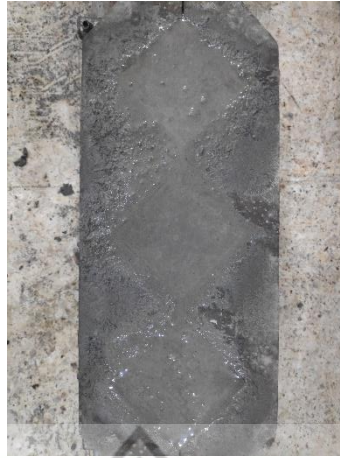
Gambar P.5 Permukaan Mortar Diratakan
