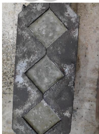
Gambar O.10 Permukaan Mortar Diratakan
