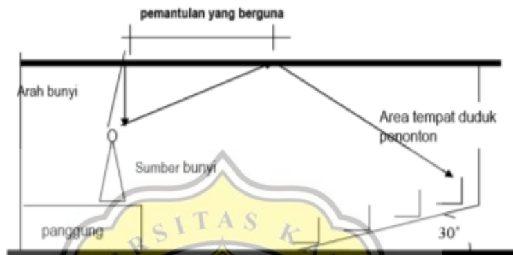
Gambar 5. 6 Bentuk plafond paralel yang tidak dianjurkan Sumber : Doelle (1990)
