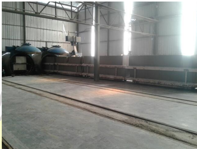
Gambar 1 cake atau adonan bata yang siap dimasukkan ke dalam mesin autoclave untuk dimasak agar adonan dapat menjadi padat
