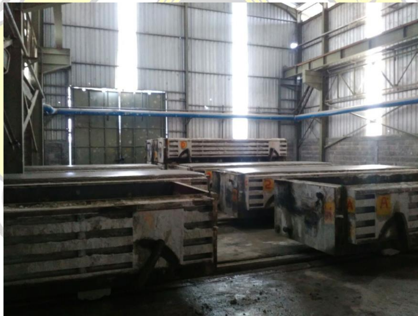
Gambar 4 trolley yang telah diisi adonan dari divisi precuring yang dидiamkan selama 4 sampai 5 jam agar mengembang, sebelum dimasukkan ke dalam mesin autoclave
