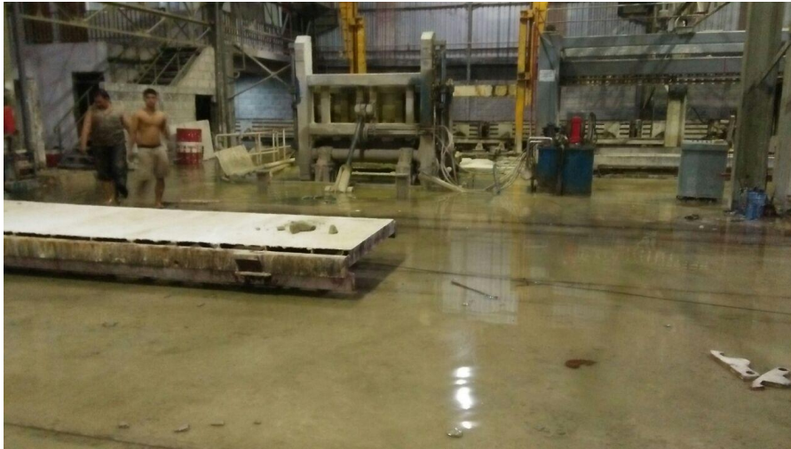
Gambar 5 pallet yang di atasnya terdapat trolley cake untuk mempermudah proses ekspor adonan dari divisi precuring ke divisi cutting line
