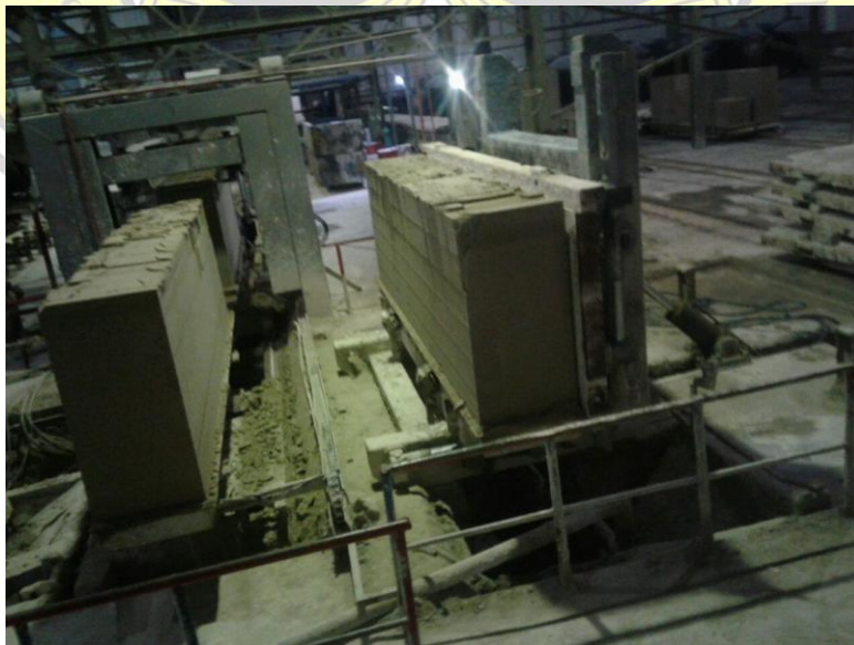
Gambar 2 Kondisi bata yang sudah dipotong rapi dan presisi oleh divisi cutting line
