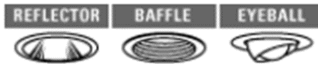
Gambar 43 Armatur Yang Biasa Digunakan Untuk Accent & Task Lighting
