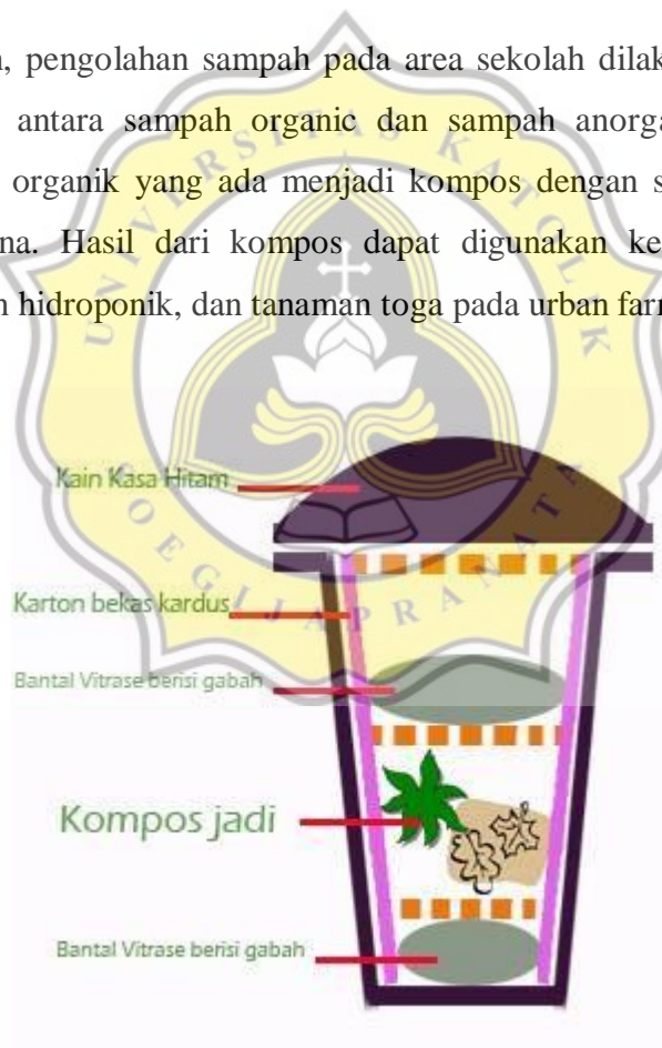
GAMBAR 69 Proses pengolahan sampah sederhana (sumber : program PKK bandung ( http://tppkk.bandung.go.id/artikel/semuaartikel/metode-pengolahan-sampah-organik-menjadi-kompos-dengan-keranjang-takakura-untuk-menghemat-energi ))
