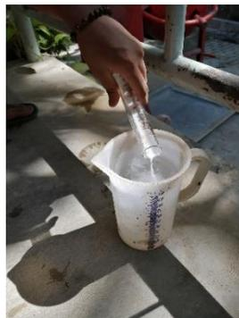
Gambar 3.6 Pencampuran Air dengan POLCON®
