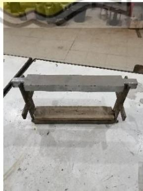
Gambar 3.10 Alat Bantu Perletakan Benda Uji / Jig
