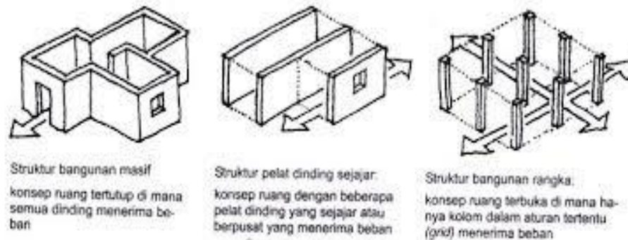
Gambar 6.31 Contoh jenis struktur bangunan
