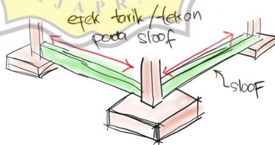
Gambar 6.24 Contoh sloof penghubung antar pondasi
