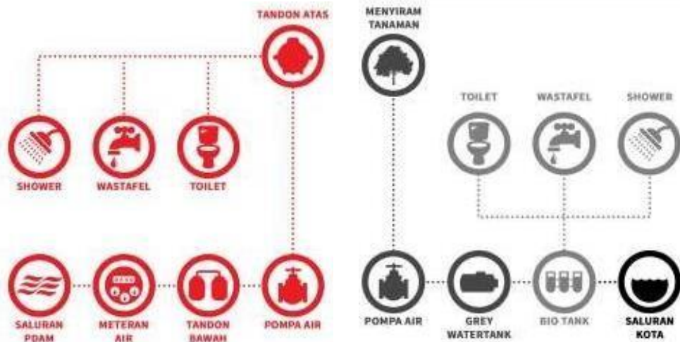
Gambar 51 Diagram Skema Air Bersih (kiri), Diagram Skema Air Kotor (kanan)
