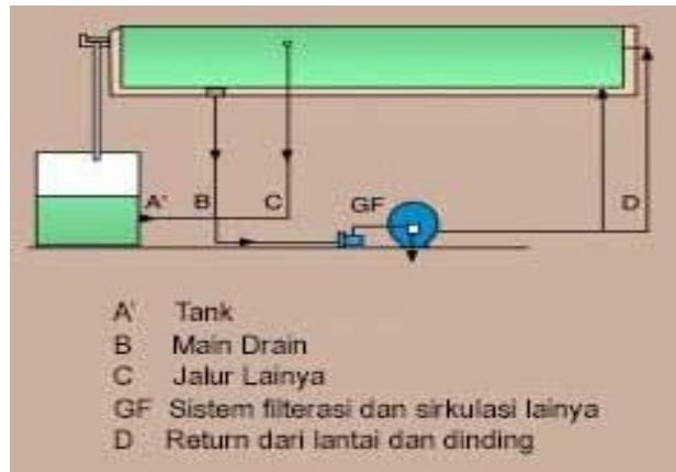
Gambar 27 skema sirkulasi kolam overflow
