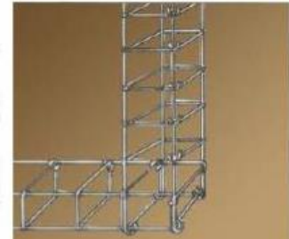
Gambar 8 Pembesian pada tiang-tiang dan slop
