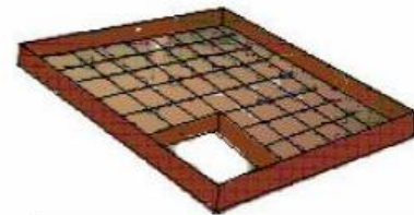
Gambar 16 Pemasangan cetakan dan pembesian tutup PAH
