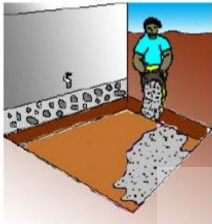
Gambar 22 Pengupasan tanah dasar 1,20 m dan pengurugan tanah
