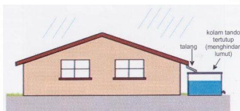
Gambar 35. Sketsa kolam pengumpulan air hujan di atas tanah
