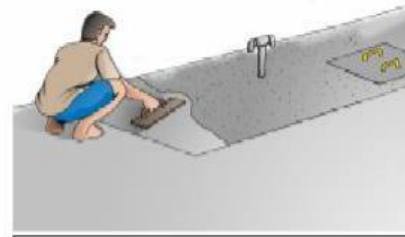
Gambar 21 Pekerjaan plesteran tutup bak
