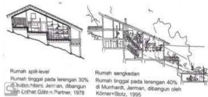
Gambar 4.9 Pengolahan Lahan pada tapak di lereng
