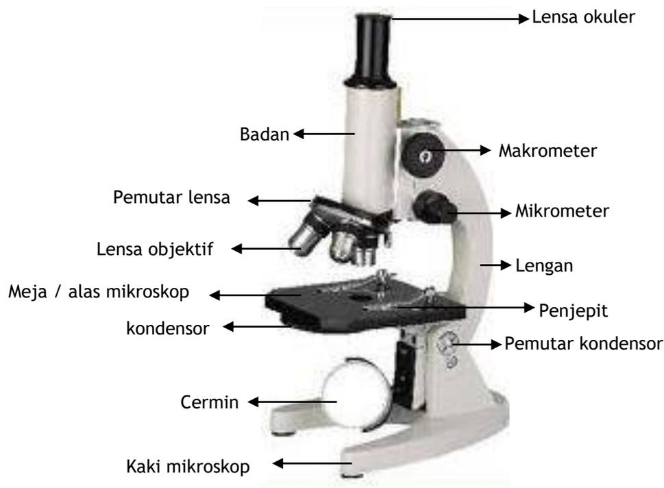
Gambar 1. Bagian-bagian Mikroskop (sederhana)
