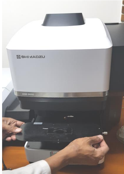
Gambar 21. Pemasangan ATR Pressure Sensor pada AIM-9000
