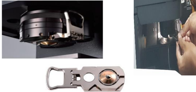
Gambar 29. Pemasangan ATR Objective pada AIM-9000
