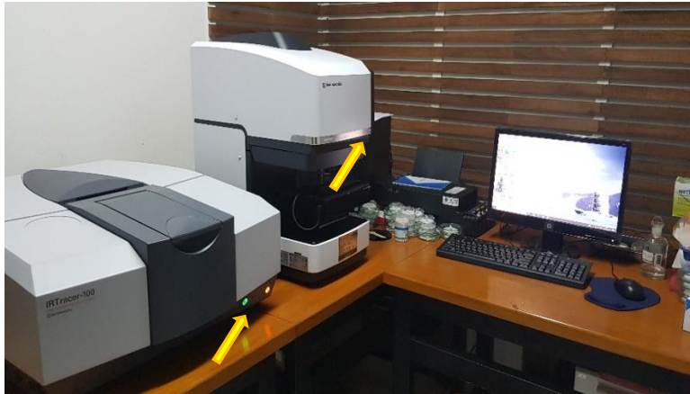
Gambar 24. Semua instrumen dan komputer dalam kondisi menyala (tanda panah menunjukkan indikator lampu pada IRTracer-100 dan AIM-9000)
