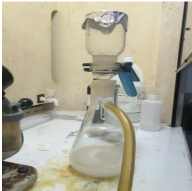
Gambar 9. Proses penyaringan sampel paska digesti
