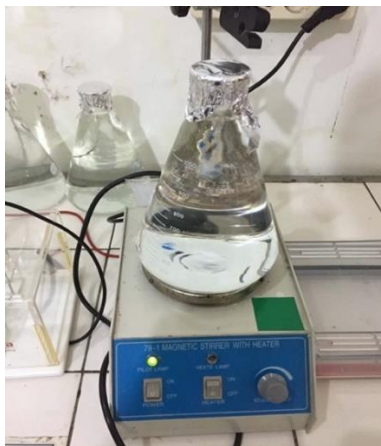
Gambar 3. Pembuatan larutan NaCl jenuh ( 1,2 \text{ g/cm}^3 )
