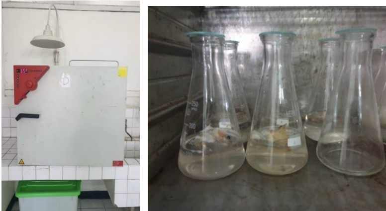
Gambar 7. Inkubasi sampel di oven yang bersuhu 65°C
