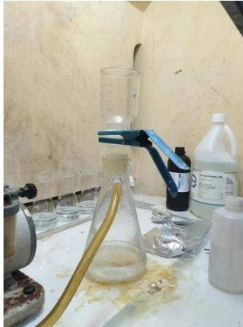
Gambar 4. Proses penyaringan pelarut yang digunakan untuk analisis
