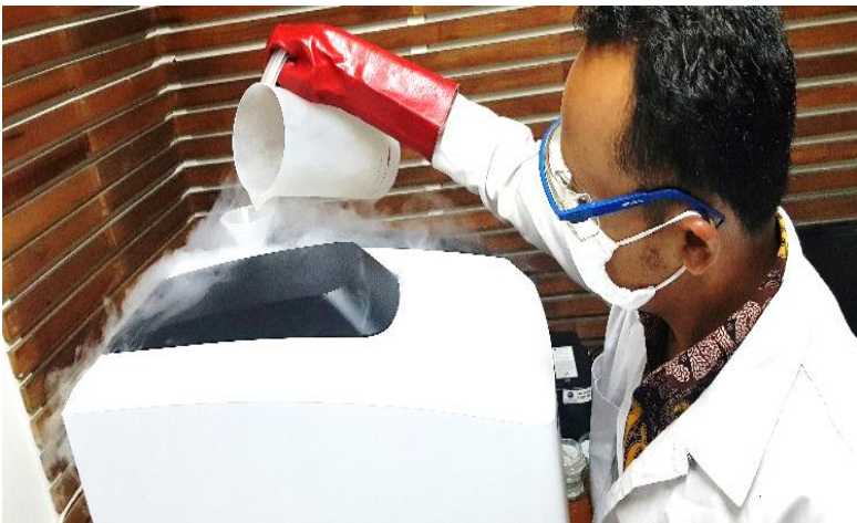
Gambar 23. Pengisian nitrogen cair ke AIM-9000
