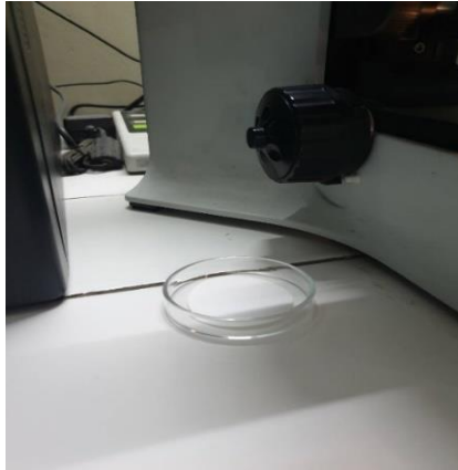
Gambar 14. Peletakan kertas saring bersih di samping mikroskop selama pengamatan berlangsung sebagai kontrol kontaminasi dari udara dan lingkungan sekitar
