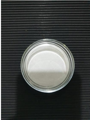
Gambar 13. Kertas saring yang berisi partikel yang diduga mikroplastik
