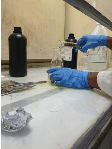
Gambar 6. Penuangan 30% H 2 O 2 ke sampel yang dilakukan di lemari asam
