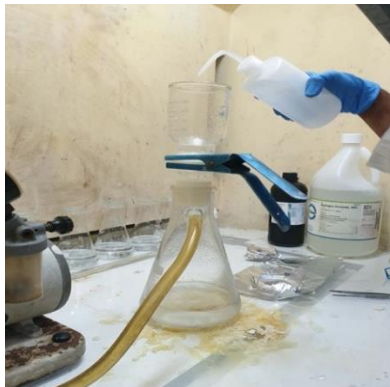
Gambar 12. Penyaringan sampel hasil pemisahan berdasarkan densitas
