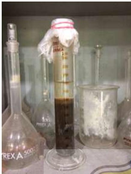
**Gambar 4.48** Uji Hidrometri
