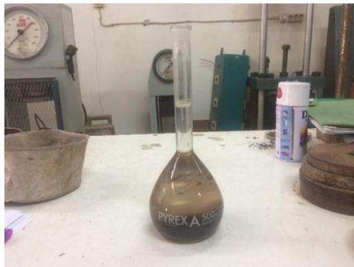
Gambar 4.30 Piknometer Berisi Agregat Halus dan Air
