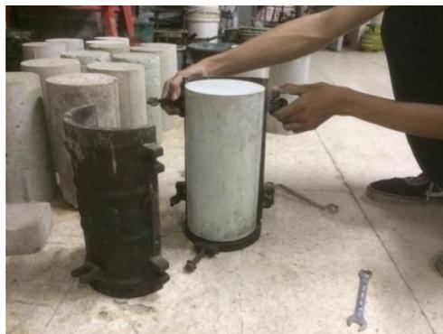
Gambar 4.50 Pelepasan Cetakan Benda Uji
