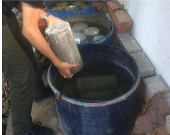
Gambar 4.51 Proses Perawatan Benda Uji Dengan Air Rob
