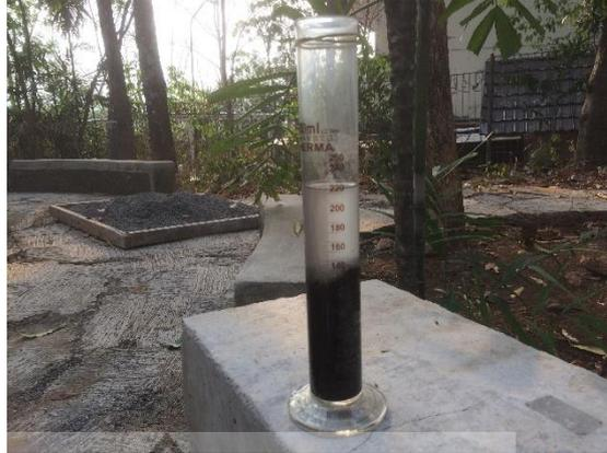
Gambar 4.11 Gelas Ukur Berisi Agregat Halus dan NaOH
