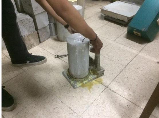
Gambar 4.53 Proses *Capping* Pada Benda Uji
