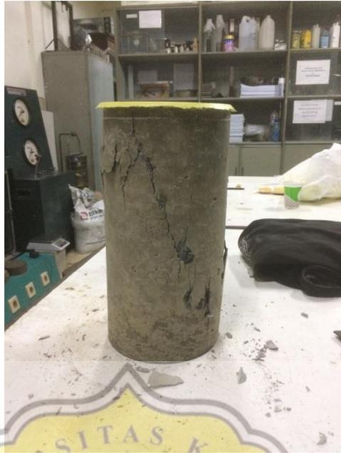
Gambar 4.63 Pola Retak Beton Variabel D
