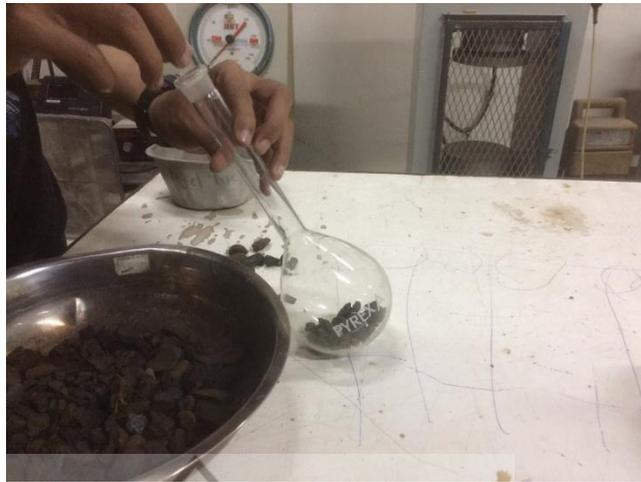
Gambar 4.35 Agregat Kasar Dalam Piknometer
