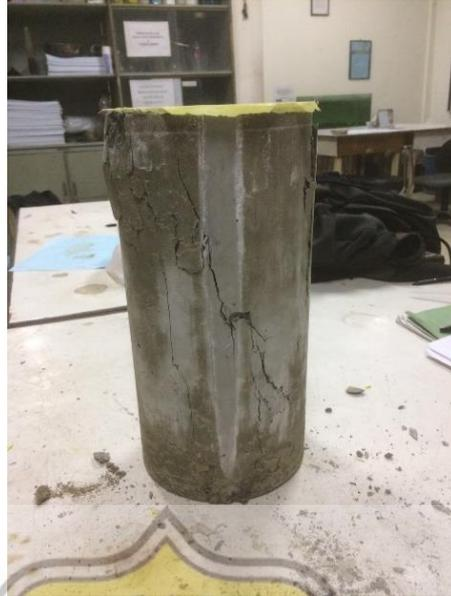
Gambar 4.61 Pola Retak Beton Variabel B
