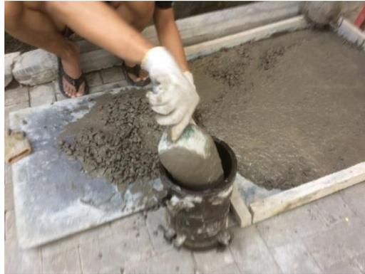
Gambar 4.48 Proses Memasukan Adukan Kedalam Cetakan
