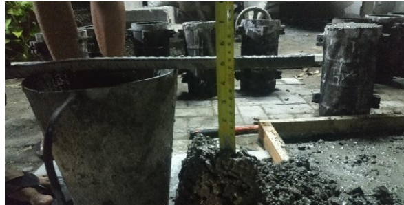
Gambar 4.63 Nilai Slump Kadar 4%
