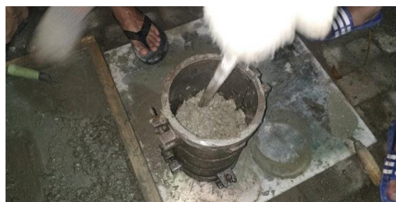
Gambar 4.75 Merojok Beton Dalam Cetakan
