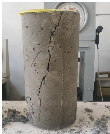
Gambar 4.91 Pola retak pada beton konsentrasi 6%
