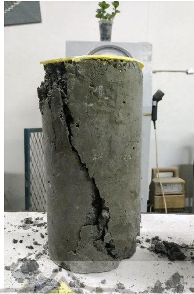
Gambar 4.89 Pola retak pada beton konsentrasi 2%
