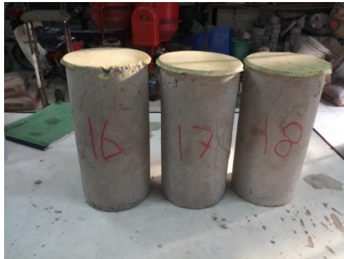
Gambar 4.82 Pola Retak Benda Uji Pasir Asli 1% - 28 Hari
