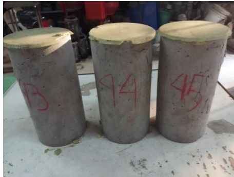
Gambar 4.85 Pola Retak Benda Uji Pasir Cuci 1% - 28 Hari
