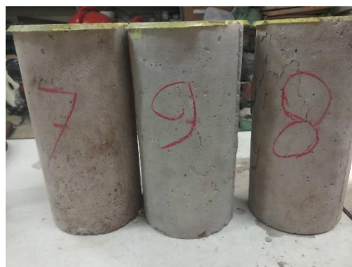
Gambar 4.81 Pola Retak Benda Uji Pasir Asli 0% - 28 Hari
