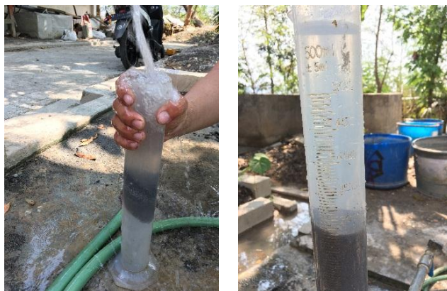
Gambar 4.8 Proses Menghilangkan Kadar Lumpur
