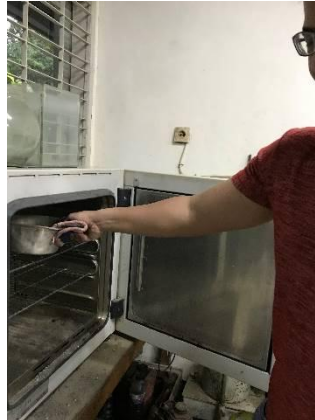
Gambar 4.9 Pengeringan Pasir dengan Oven
