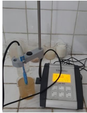
foto 6. Pengukuran pH dengan pH meter
