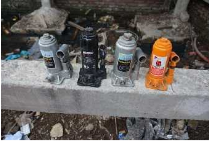
Gambar 4: Alat dongkrak hidrolis (dongkrak mobil) yang digunakan untuk menaikkan lantai rumah panggung.
