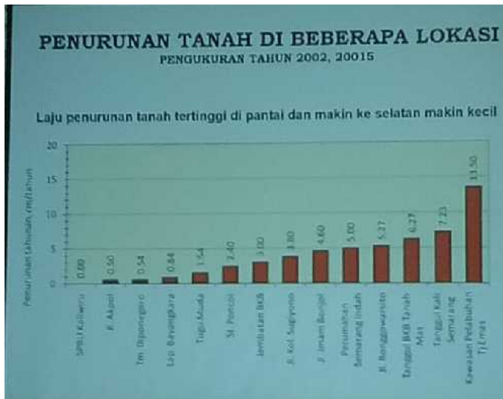
Penurunan tanah di beberapa lokasi di Semarang Sumber: Ashari MH, 2018
