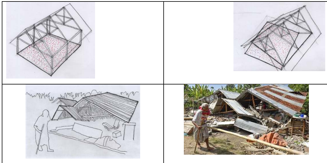
Gambar 11: Model kerusakan konstruksi pada type rumah beratap pelana berbahan seng, gempa bumi Lombok 2018.
