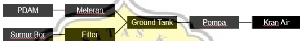
Diagram 5 1 Proses Penyaluran Air dalam Bangunan
