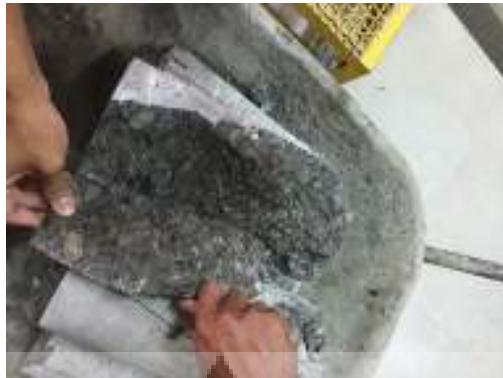
Gambar 4.68 Rongga Pada Benda Uji M-Sand 1%
