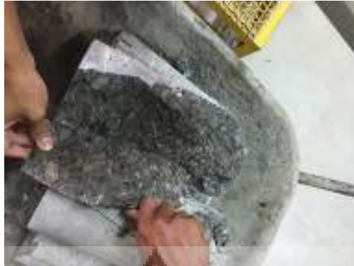
Gambar 4.68 Rongga Pada Benda Uji M-Sand 1%
