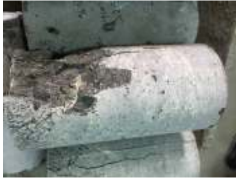
Gambar 4.65 Keretakan Benda Uji M-sand 1% umur 14 Hari
