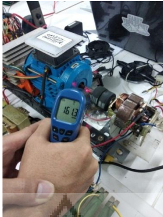
Gambar 4.38. Kecepatan motor BLDC pada duty cycle 25%
