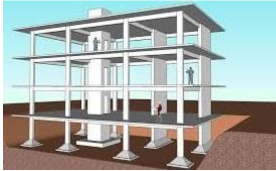
Gambar 7.5. Struktur rangka bangunan
