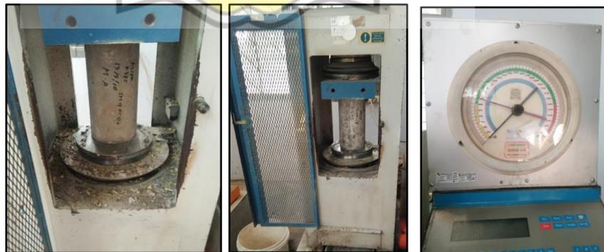
Gambar 3.73 Pengujian Kuat tekan beton di Laboratorium
