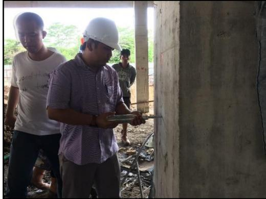
Gambar 3.80 Pengujian Hammer Test
