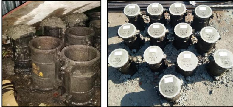
Gambar 3.71 Pembuatan benda uji silinder
