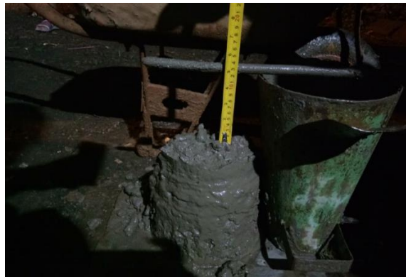
Gambar 3.60 Uji Slump Test Sumber : Dokumentasi Proyek, 2018
