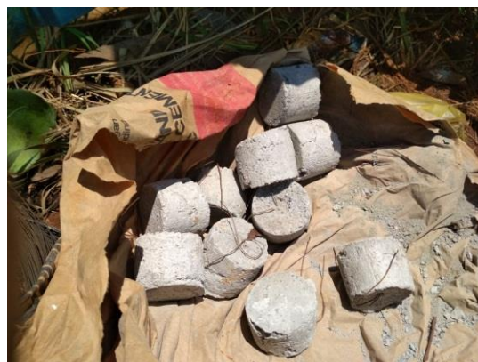
Gambar 3.55 Beton Decking Sumber: Dokumentasi Proyek, 2018
