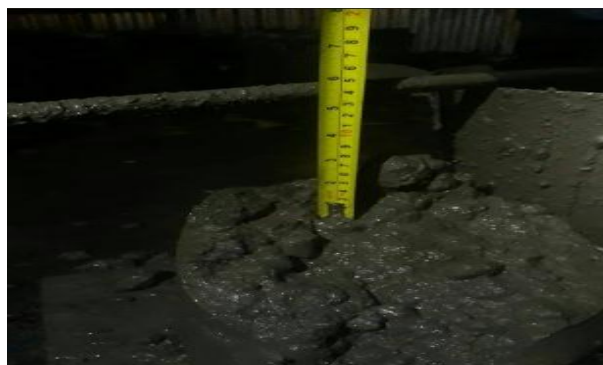
Gambar 3.64 Nilai Uji Slump Test
