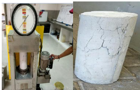
Gambar 4.39. Mesin Dijalankan Hingga Benda Uji Runtuh
