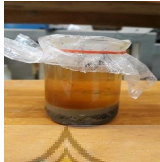
Gambar 4.17. Hasil Kandungan Kadar Organis Pasir Muntilan
