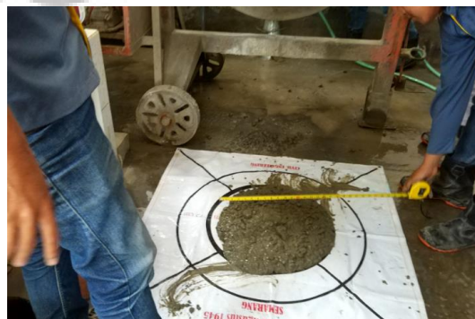
Gambar 4.34. Slump Test dan Flow Test
