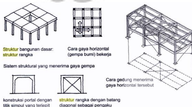
Gambar 4. 1 Struktur Rangka Sumber: Pedoman Bangunan Tahan Gempa
