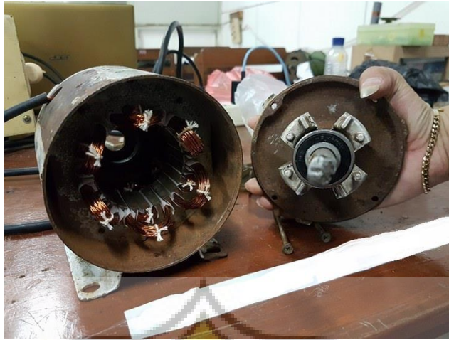
Gambar-3.2 Motor switched reluctance dengan empat rotor dan enam stator
