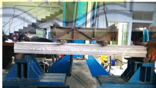
Gambar 3.13. Tumpuan Beban sebagai Representasi Mekanisme Pembebanan Third Point Loading
